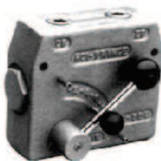
RD 100 e RD 1900 são válvulas reguladoras de vazão compensadas. Movendo a avalancha, a vazão da conexão "CF" (vazão controlada), varia de acordo com a tabela. Toda a vazão restante é derivada na conexão "EF". Esta vazão poderá ser utilizada para alimentar outro circuito ou retorná-la ao tanque. Uma vez fixada a vazão controlada "CF", será mantido aproximadamente constante com variações de pressão nas duas saídas.
